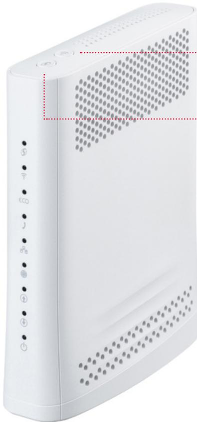
Wi-Fi: Direkt am Gerät kann Wi-Fi aktiviert und deaktiviert werden. Netzwerkname und Passwort werden im WWZ-Cockpit geändert (Siehe Punkt 3 WLAN Einstellungen).
